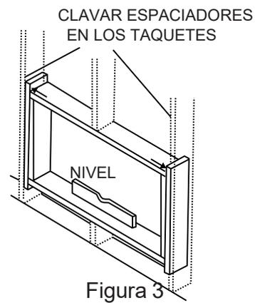
**NOTA:** Si el grosor de la pared es de 8 1/2" (22 cm) o más, agregue un tapajuntas de aluminio sobre la parte inferior de la apertura del marco para asegurarse de que no entre agua entre la pared interior y la exterior.
