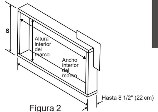
4. Construya un marco de madera con las dimensiones INTERNAS que aparecen arriba para su modelo (recuerde medir dos veces). La profundidad del marco debe ser igual al grosor de la pared. Llene el espacio que hay entre la abertura y los taquetes con espaciadores de madera, como se muestra aquí.
