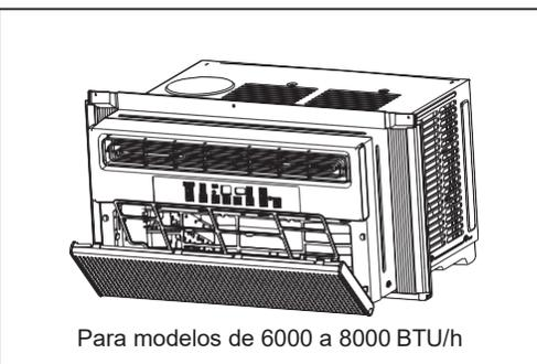
Debe revisar el filtro de aire al menos una vez por mes para determinar si hace falta limpiarlo. Las partículas atrapadas en el filtro se pueden amontonar y provocar la acumulación de hielo en los serpentines de refrigeración.
