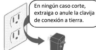
Cable de alimentación con enchufe de conexión a tierra de tres patas y dispositivo de detección de corriente.
