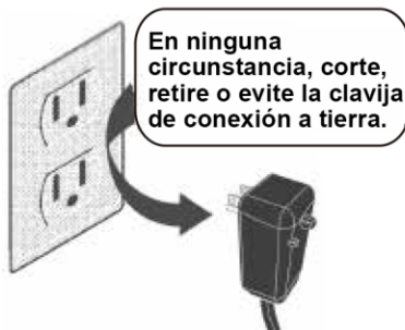
Cable de alimentación con enchufe de 3 clavijas y dispositivo de detección de corriente
