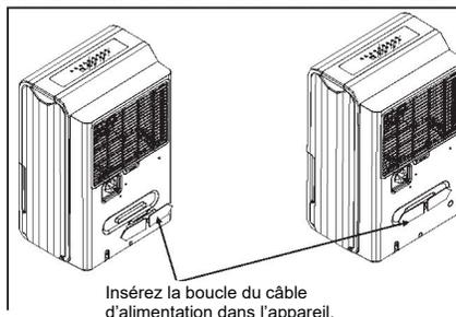
Insérez la boucle du câble d'alimentation dans l'appareil.
