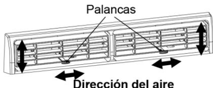
Las rejillas le permiten dirigir el flujo del aire hacia arriba o hacia abajo (en algunos modelos) o hacia la izquierda o hacia la derecha a través de la habitación según se requiera. Gire las rejillas horizontales hasta lograr la dirección arriba/abajo deseada.
